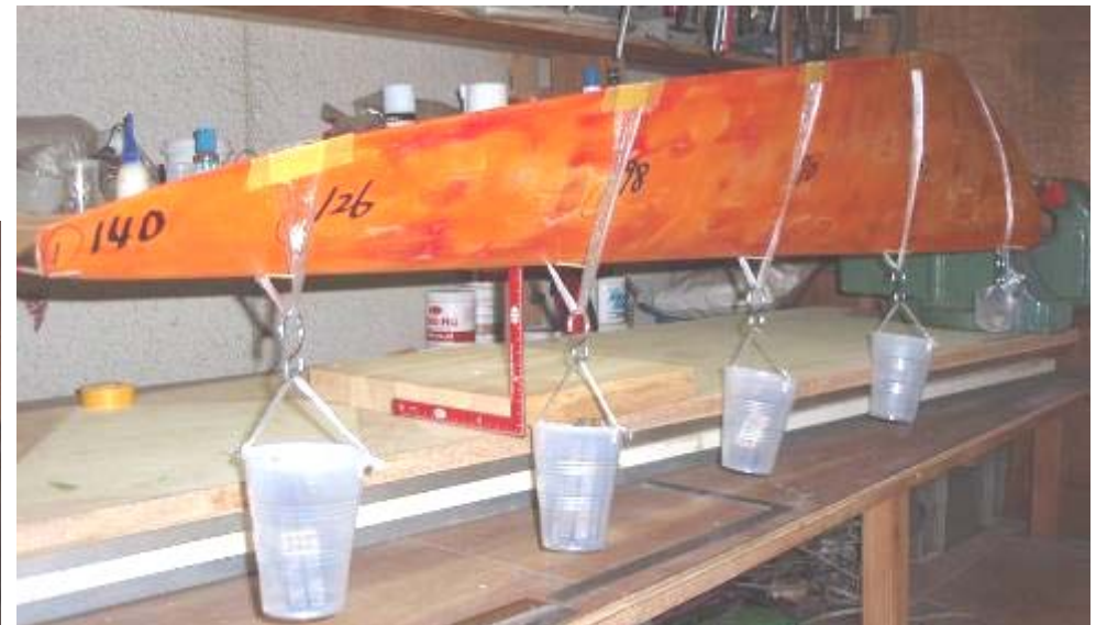
ブレードの変位測定 (荷重倍数: 1.6倍)
