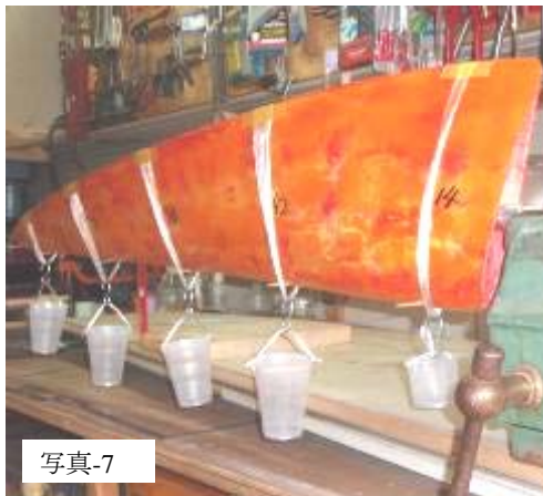
写真-7 ブレードの初期値の測定
