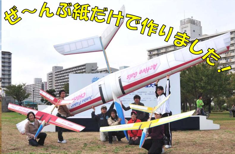
“CHick-GRX”は、翼長 7.6m、全長 3.94m、重量 17kg で、紙だけで製作されています。ご覧のように、主翼には前進角、尾翼に V テールの揚力尾翼と、独特のフォルムの機体です。パイロットと左右のウイングランナー、テールランナーの 4 名の数十回に及ぶランニングテストと微調整を繰り返し、数人のサポーターの協力のもとに飛行に臨みました。当日は、ジャンボ紙飛行機のフライトに申し分のない天候で、4 名の息もピッタリ！ 大勢のギャラリーの注目の中、見事な大フライトで優勝に輝きました。機体は無傷で回収でき、今回の壁面展示の運びとなりました。
