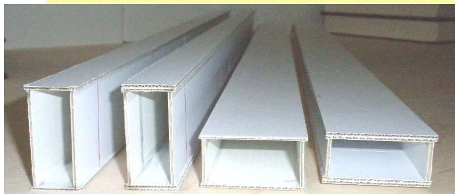
写真-4 試験体の断面形状 左から、桁 A1,A2,B1,B2
