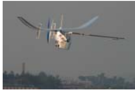
カナード、二重反転&プッシャープロペラ、主翼に取り付けた2枚の垂直尾翼など独特の設計製作技術を駆使した 'Puls' の見事なフライト
