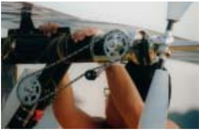
思わず覗き込む二重反転ドライブユニット 細部に渡って緻密な設計が伺われる。
